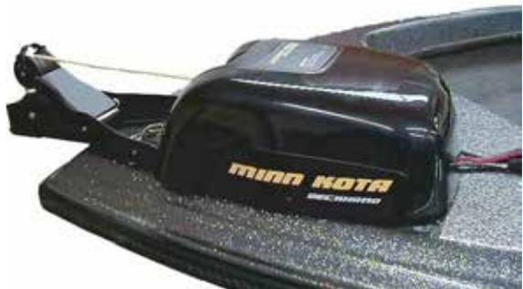
7. Проверьте, чтобы под палубой в месте размещения балки и лебедки не было никаких конструкций. Если такие имеются, найдите другое место расположения прибора.
