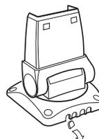
Рис.25: места выламываемых пазов для проводки кабелей
